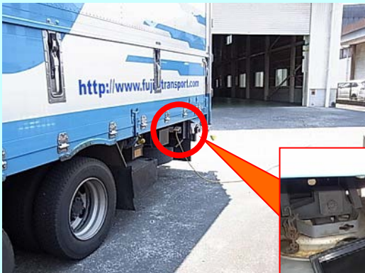
トラック後部に接続電源ケーブルをつなぎます
