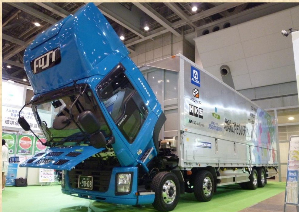
富士運輸(株)様保有の大型CNGトラック(車両総重量25トン)を展示。メーカー担当者等がCNGタンクの位置やCNGエンジンを確認していた。
