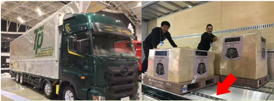
新型日野プロフィアの完成車をベースにセノプロ仕様にドレスアップしました。荷室には重いパレットを楽に移動できるハイドローラー(※)を取り付けています。ハイドローラーは普通のウイング車に1日で取り付けが可能です。
